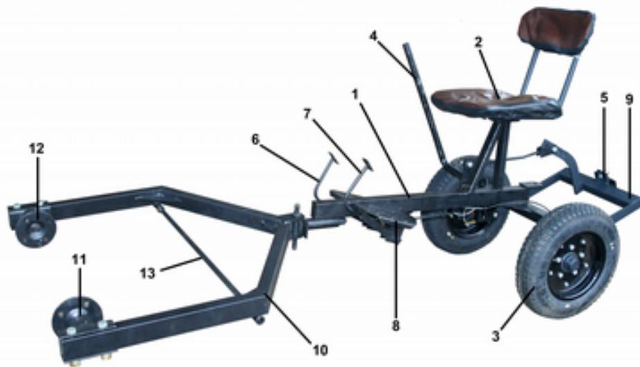
Рис.2 1- рама прицеп-адаптера, 2- сиденье, 3-колеса в сборе, 4- рукоятка подъёма, 5- сцепка двойная СА-2, 6- педаль тормоза, 7- педаль фиксатора, 8-упоры для ног, 9-рама подъема, 10-вилка -полурама, 11-подшипниковый блок, 12-полуось подшипникового блока, 13-ограничитель.
