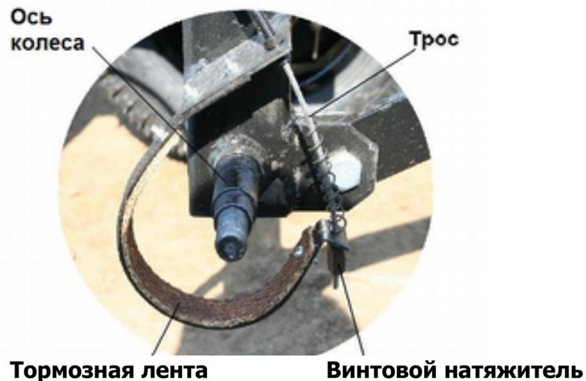
Рис. 1 Тормозная система
